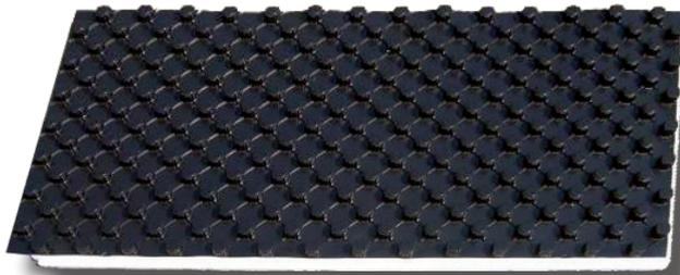
Pannello in EPS classe 150/200 presagomato per la realizzazione di sistema di riscaldamento a pavimento accoppiato a termoformato rigido superiore in pst sp.0,8 mm, avente sottoquadra pronunciati per il bloccaggio di tubazioni con diametro esterno 16-18 mm.
