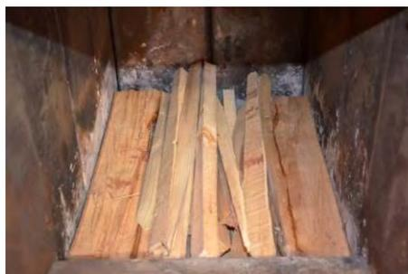
5. Posare materiale infiammabile su piccoli legni secchi. Con il materiale, sarai in grado di accendersi attraverso la porta di caricamento.
