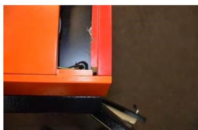
Se la temperatura della caldaia diminuisce, è possibile utilizzare un piccolo cacciavite per premere il tasto rosso STB e disattivare il termostato. La caldaia può essere riaccesa. Il sensore della caldaia e il sensore del termostato di sicurezza si trovano nell'angolo in alto a destra della caldaia.
