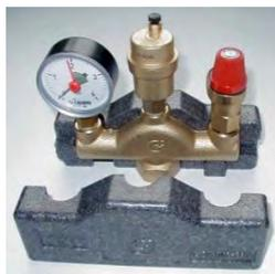
Tutte le caldaie installate devono essere conformi alle norme di sicurezza tecnica secondo EN 12828: 2003 L'elemento più importante è la valvola di sicurezza che si apre a massimo 3 bar e rilascia l'acqua di riscaldamento sotto forma di vapore. È necessario installare un tubo che scarichi acqua calda nel sifone.
