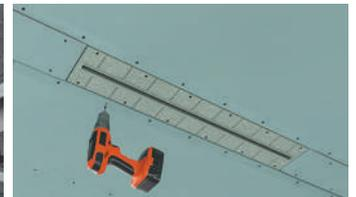
Il modello **SINGLE PUZZLE** deve essere fissato ai profili in alluminio del controsoffitto e può dare origine a diffusori lineari di qualsiasi lunghezza multipla di 1 metro, tramite l'utilizzo dei segmenti aggiuntivi e le testate di finitura. La tecnologia **PUZZLE LOCK** permette di collegare i segmenti del diffusore in modo molto preciso e veloce.
