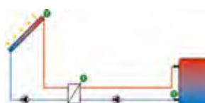
Scambiatore di calore esterno, logica di controllo pompe (1 x Q00146 anche necessario)
