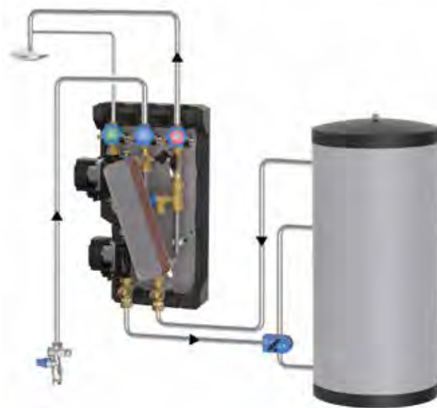
Esempio di montaggio: FriwaMini senza circolazione Esempio di montaggio: FriwaMini con circolazione, kit distribuzione ritorno (cod. art. 640425), valvola di campionamento (cod. art. 640422), gruppo di sicurezza accumulatore di acqua sanitaria (cod. art. 563907)
