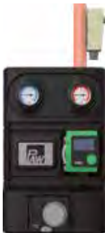
K33R circuito di regolazione a valore costante, elettronico, valvola miscelatrice a 3 vie con bypass 0-50%
